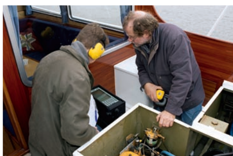
Meten van geluid en trillingen op de Tijgerhaai door de ingenieurs van Sonus. We beginnen met het in kaart brengen van de oude situatie: de Vetus-Peugeot diesel met V-drive. Op basis hiervan weten we precies wat ons werk uiteindelijk oplevert.
